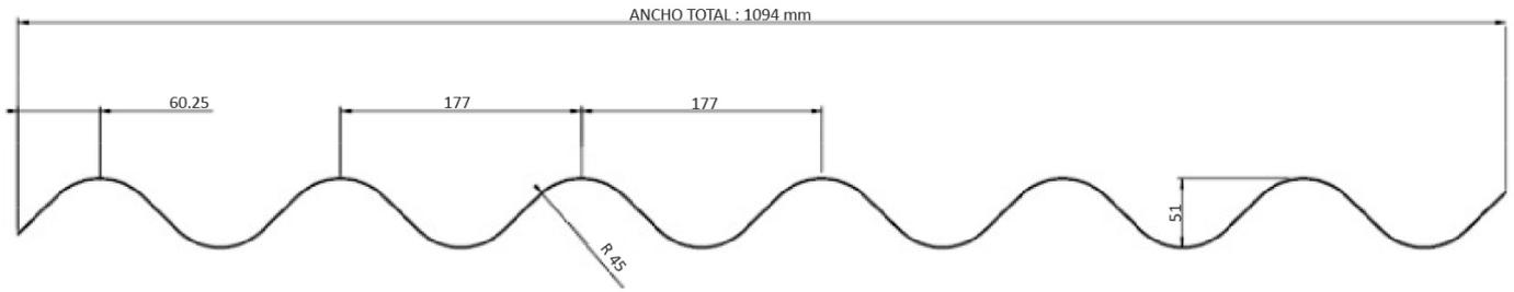
Las placas de poliéster Onduline PLR Gran Onda están constituidas por resina de poliéster reforzada con fibra de vidrio. Las placas de Onduline PLR Gran Onda están protegidas por ambas caras con un gel coat específico para evitar el desfibrado a lo largo del tiempo y protegidas contra los rayos UV, garantizando la estabilidad de la transmisión luminosa en el tiempo.
